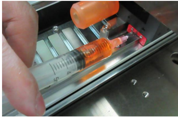
圖 7.1.4.1.3 SSA 08,10, MGN滑塊潤滑保養套件
