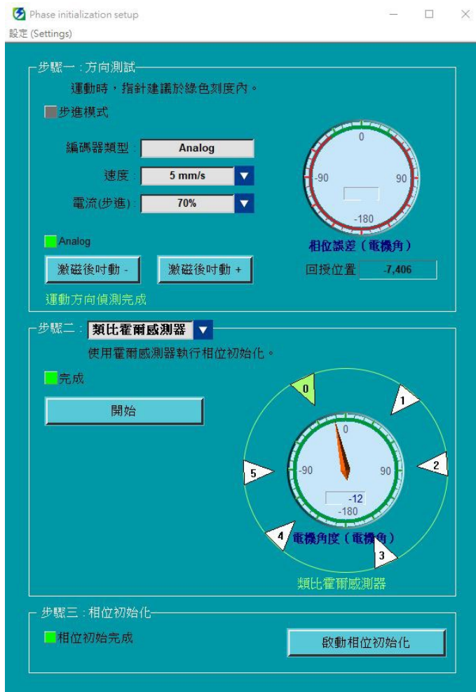
圖7.5.4.1 類比霍爾感測器操作流程
