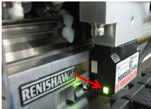
(b)Renishaw 讀頭間距為 0.8 \pm 0.15\text{mm}
